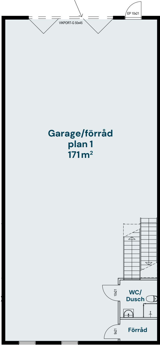
Garage/förråd inklusive toalett och dusch.
